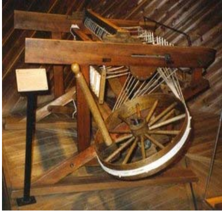
Fig. 1 Modelo de la Spinning Jenny en un museo en Wuppertal, Alemania.
