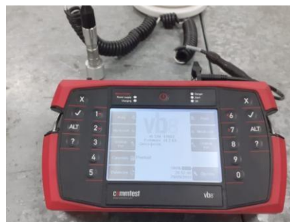
Figura 5 Medidor de espectros de vibración COMTEST vb8.
