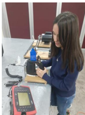
Figura 7 Medición del espectro de vibración de la caladora.
