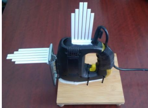
Figura 4 Resonadores colocados sobre la caladora.
