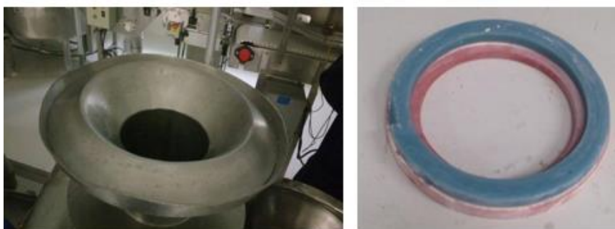
Ilustración 2. Cono y empaque dañados.
