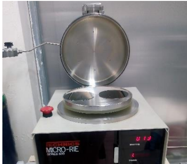
Figura 4.11. Erosión de película de poliimida 2610/2611 en sistema microRIE.
