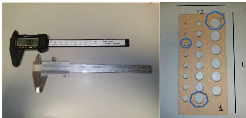
**Figura 3.** Instrumentos de medición y medidas a realizar en R&R.
