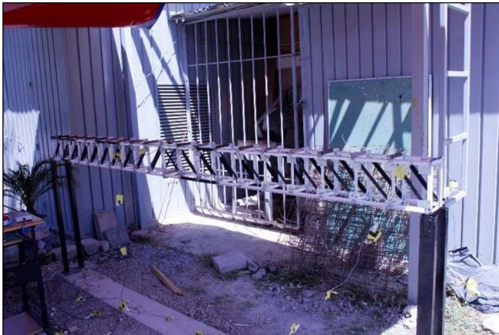
Figura 4.1 Colocación del ensaye para las aceleraciones de respuesta
