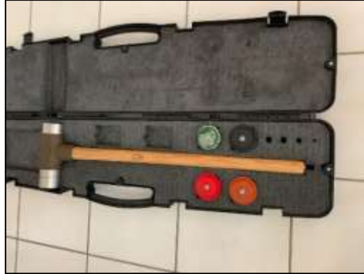
Figura 3.12 Martillo con medición de fuerza de impacto, con cabezales
