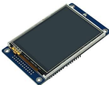
Figura 17. Display de cristal líquido de 3.2 pulgadas
