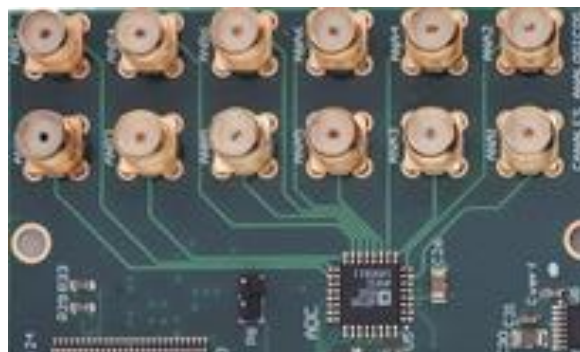
Figura 14. Conectores para las entradas del convertidor
