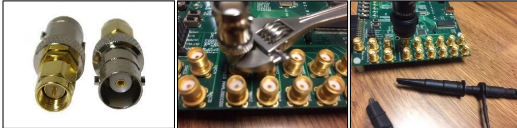
Figura 15. Adecuación de conexión SMA a BNC
