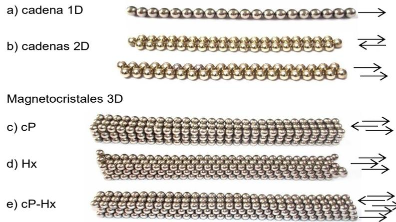
Figura 2.5: Ensamblajes de esferas magnéticas: a) cadena lineal, b) lámina cúbica y hexagonal, c) cristal cúbico, d) cristal hexagonal y e) cristal híbrido. Las flechas en color negro indican la dirección de los momentos dipolares.
