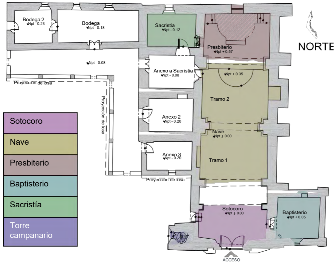
Imagen. 20. Planta arquitectónica del templo de San Agustín Obispo y sus espacios principales. Fuente: Sánchez Paulino, 2019.
