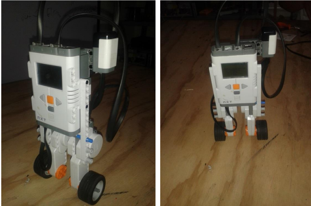
Fig. 4.37 Robot de dos ruedas en equilibrio.
