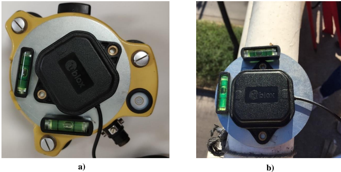
Figura 12. Estrategia de nivelación de la antena de bajo costo: a) prueba de nivelación con una base nivelante profesional, b) nivelación de la antena sobre el puente Isla Musalá.
