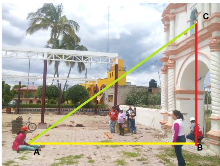
Figura 3.67. Levantamiento de alturas, in situ, templo de San Martín, mediante el proceso de trilateración. Autor: Daniel Sánchez. (2018)
