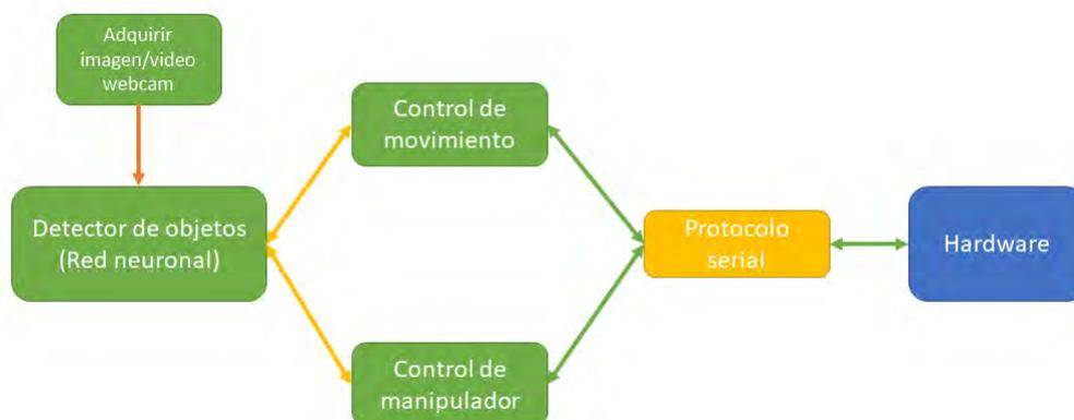
**Figura 33:** Diagrama de funcionamiento del software.<sup>12</sup>
