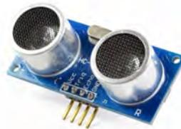
**Figura 24:** Sensor de distancia ultrasónico.<sup>3</sup>
