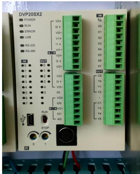
Figura 2.29 Controlador Lógico Programable marca Delta DVP20SX2
