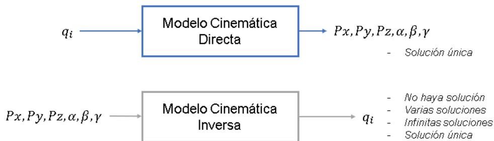
Figura 2.14 Modelos cinemática directa y cinemática inversa de un robot
