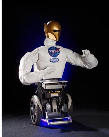
Figura 2.2 Primer robot humanoide en el espacio, tipo 5ª generación
