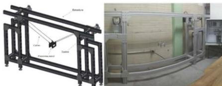
Figura 4. Robot paralelo activado por cables.
