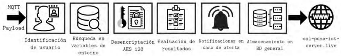
Figura 3.17: Diagrama de bloques de las funciones realizadas por el programa principal de Python.
