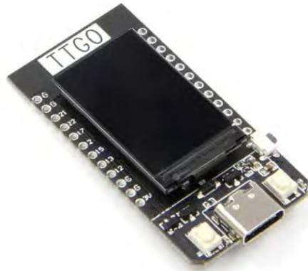
Figura 3.2: Tarjeta TTGo ESP32 de *Shenzhen Electronics* utilizada en el desarrollo del OxiPuma [Electronics, 2022].
