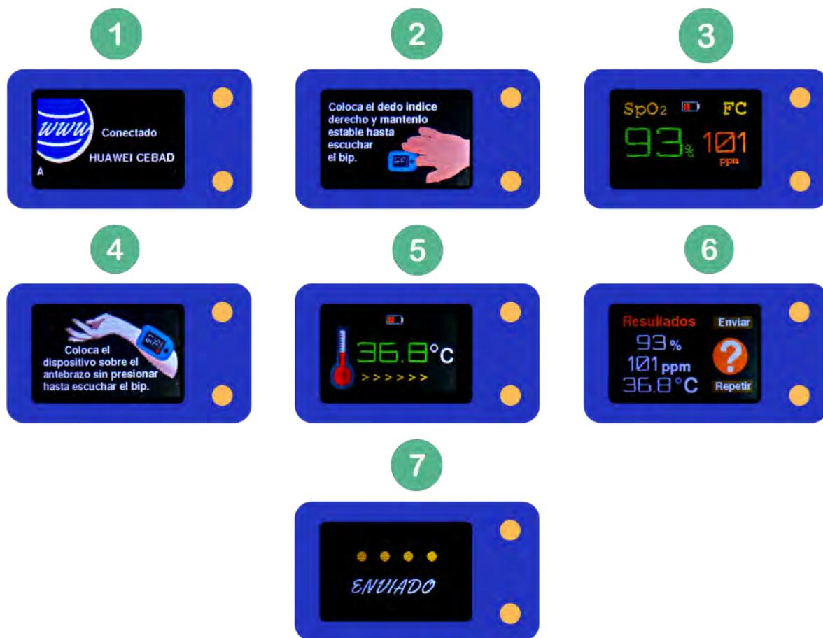
Figura 4.16: Secuencia de pantallas que se presentan en el prototipo al utilizar la función de comunicación IoT.
