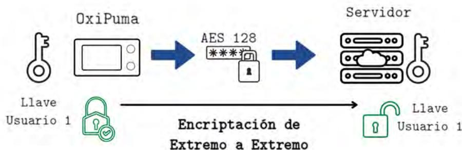
Figura 3.15: Esquema de cifrado de extremo a extremo basado en el algoritmo AES 128. En este esquema cada OxiPuma tiene una llave de cifrado que únicamente es conocida por el servidor.
