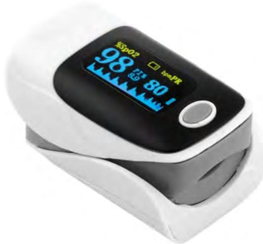
Figura 4.5: Pulsioxímetro iMDK C101A3 usado como referencia para evaluar el desempeño del OxiPuma.
