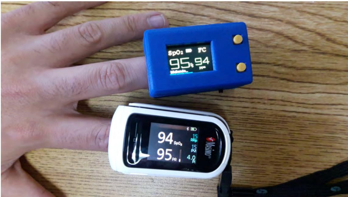
Figura 3.19: OxiPuma midiendo  $SpO_2$  y FC en un usuario real y comparado con un oxímetro comercial de la marca *Masimo MightySat*.
