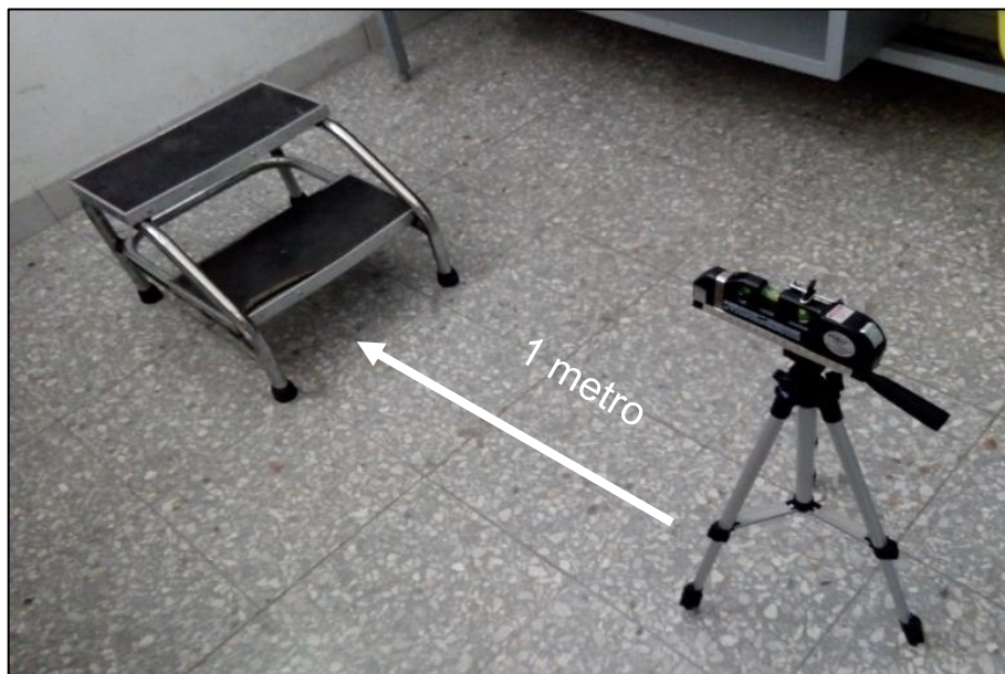
Figura 2. Colocación del nivel laser y área de exploración
