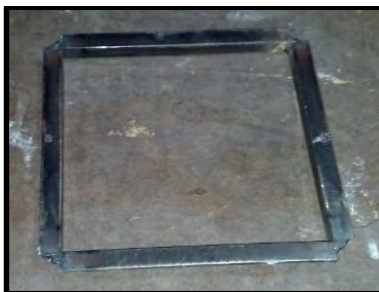
Figura 3. Molde para pruebas de conductividad Térmica
