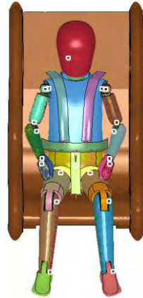
Figura 4.- Montaje de dummy en la silla con cinturón de seguridad de 5 puntos
