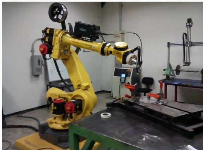
**Figura 1.** Robot Fanuc R-2000 para el proceso de soldado GTAW.
