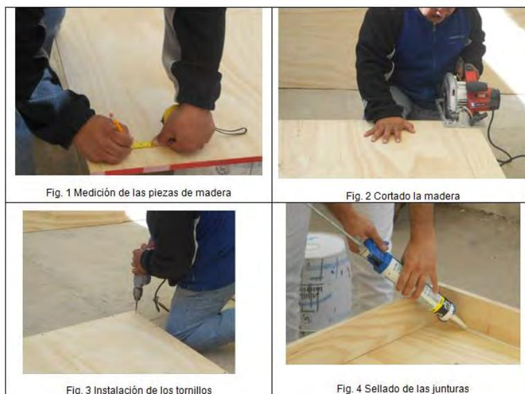
Con estos materiales iniciamos la construcción del prototipo como se muestra en las imágenes, y utilizando los materiales antes mencionados, utilizando triplay de 1/2", se hizo el armado del gabinete y sujeto con tornillos de 1/8", una vez hecho el gabinete se aplicó silicón en todas las uniones con el fin de evitar de que haya fugas de aire caliente.
