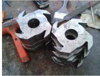
Figura 3. Cuchillas de la máquina trituradora-recicladora
