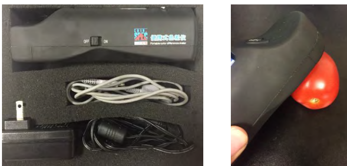
Figura 1. Colorímetro de la marca CHIN Spec para la medición de parámetros de color de frutos de tomate.
