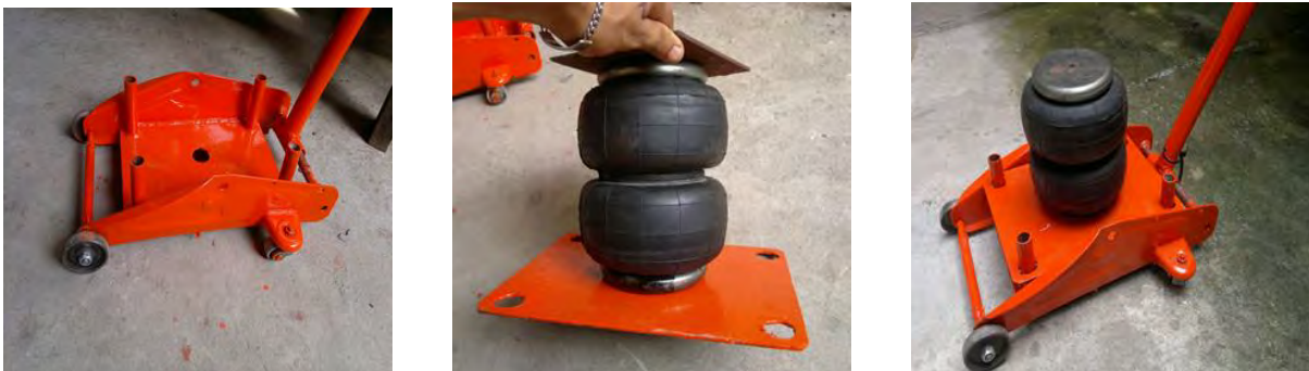
Figura 3. Construcción y ensamble del chasis con la bolsa de aire
