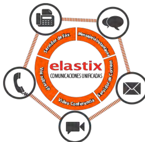
Figura 5 Funcionalidades del servidor de comunicaciones unificadas
