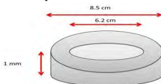
Figura 11. Dimensiones de pastilla superconductora
