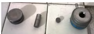
Figura 10. Molde para pastilla superconductora
