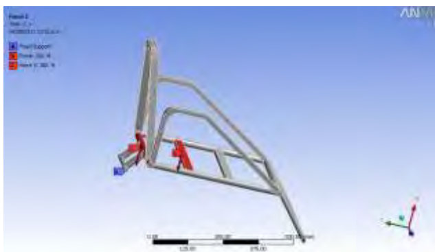
Figura 5. Estructura cargada con 500N.
