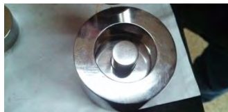
Figura 13. Molde de pastilla superconductor
