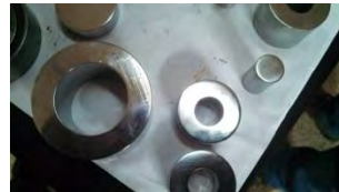
Figura 12. Partes del molde de la pastilla superconductor
