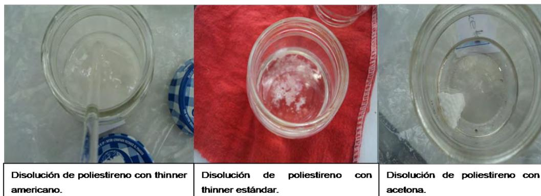
**Figura 1.** Disolución del Poliestireno en Tres Tipos de Solventes.
