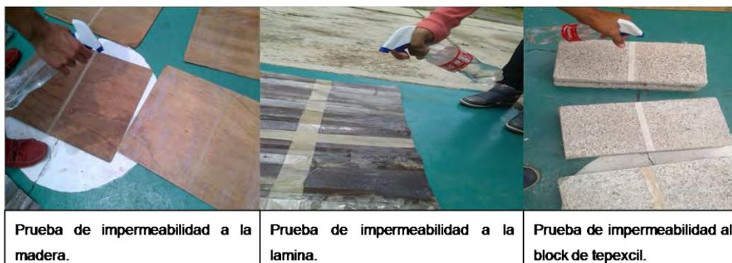
**Figura 2.** Prueba de Impermeabilidad de los Materiales.
