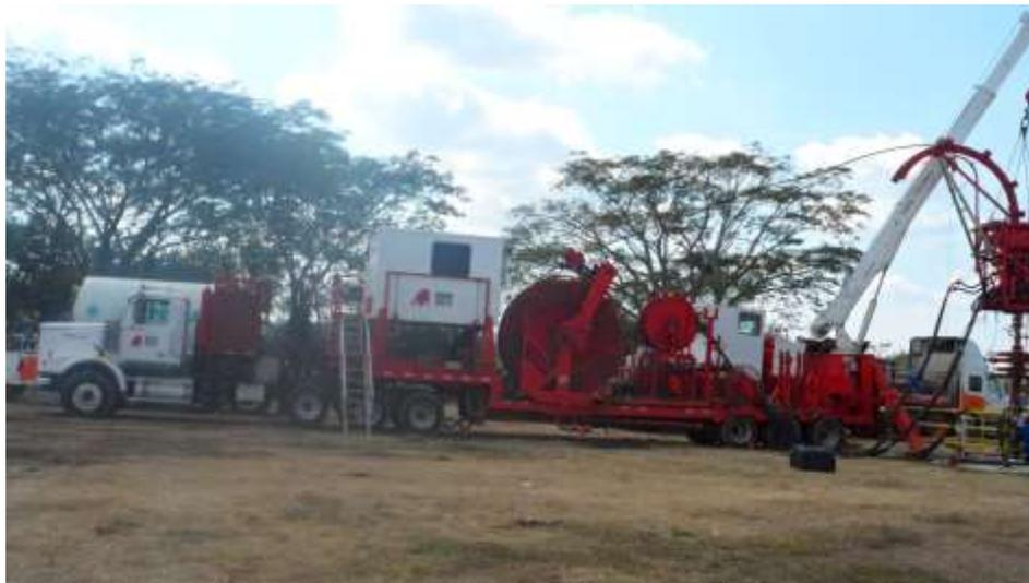
Figura 1.- Equipo de Tubería Flexible
