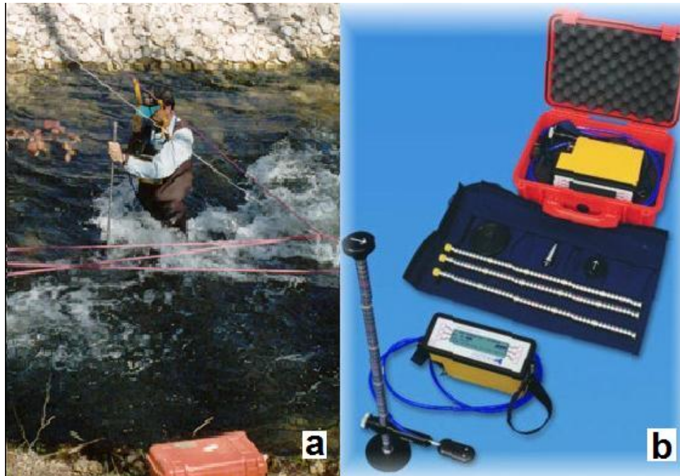
Figura 5. a. Medición de la velocidad del agua (izquierda), b. equipo electromagnético de medición, con accesorios.
