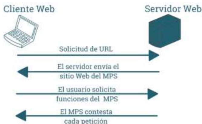
Figura 3.- Conexión Web hacia MATLAB Production Server.
