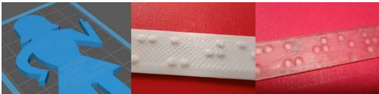
Figura 3. Caracteres Braille en FDM y MSLA
