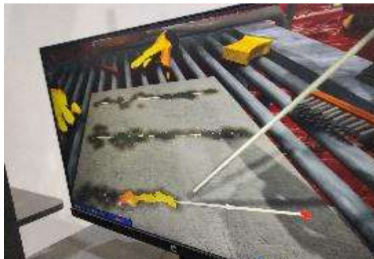
Figura 6.- Interfaz sin arco eléctrico
