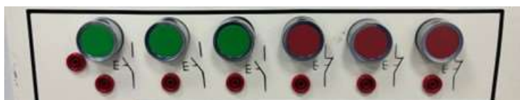
Figura 4. Botones en la tapa del Módulo Didáctico.
