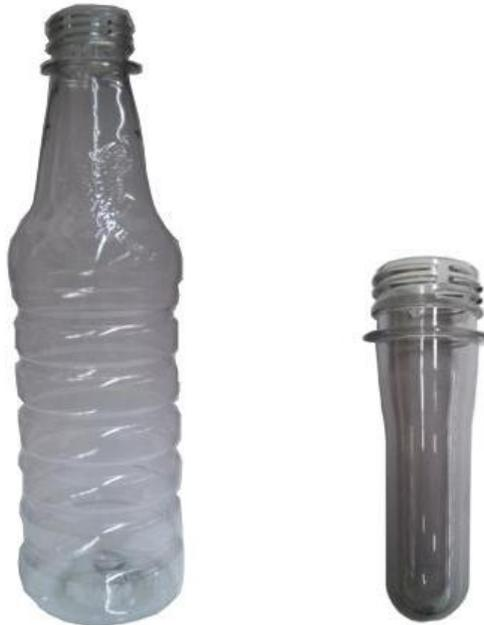
Figura 1. Envase y preforma en buen estado.
