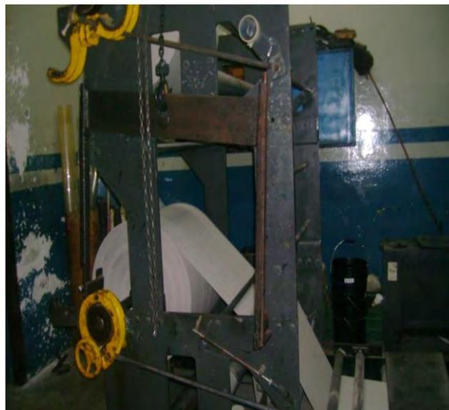
Figura 2. Montura de lámina en su parte inicial.
