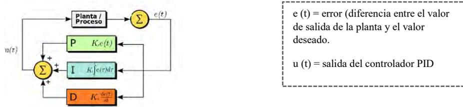
Figura 1. Diagrama de bloques de un controlador PID en un lazo realimentado.
