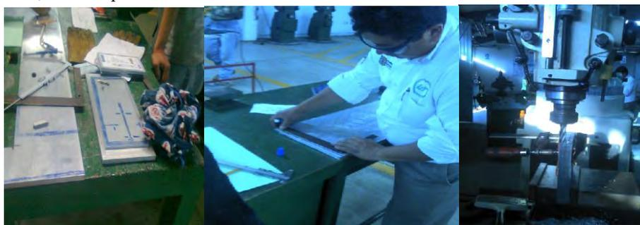
Fig. 8.- Se marcan las líneas que definen las magnitudes y realizar con facilidad el corte
