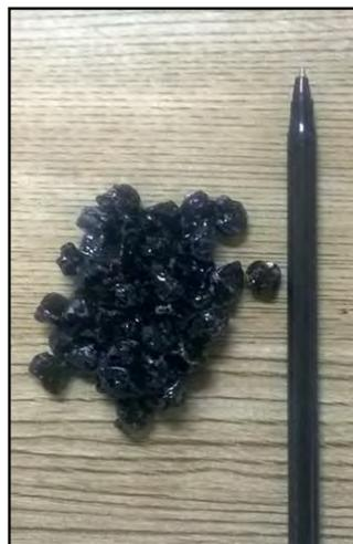
Figura 2.- Agregado de desperdicio industrial (Escoria) con y sin asfalto
