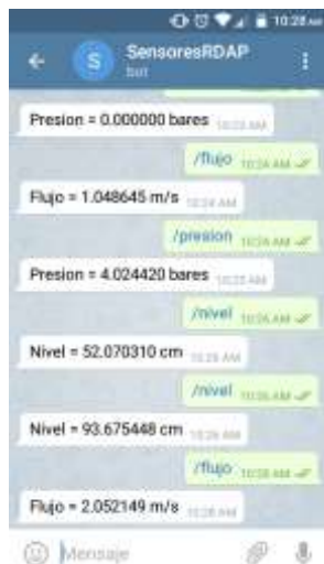
Figura 6. Solicitud de datos mediante Telegram
