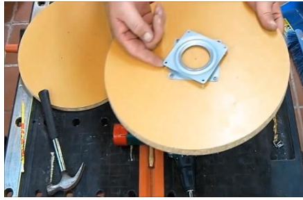
Ilustración 5. Ajustar el rodamiento en la base.
