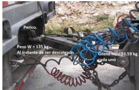
Figura 6. Distribución de cargas en lanza de acoplamiento
