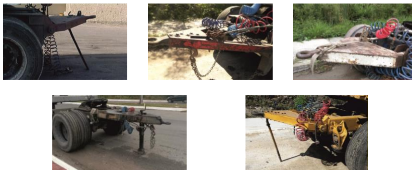
Figura 4. Soluciones rudimentarias para calzar la lanza de acoplamiento.
