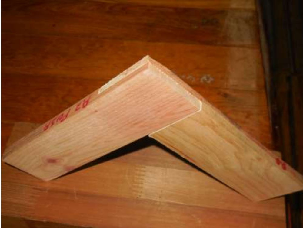
Figura 1. Ensamble a media madera
