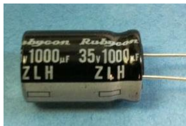
Figura 5 “Capacitor electrolítico de 1000uf a 35v”
