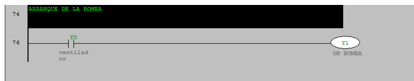
Figura. Activación de la bomba.
