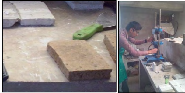
Figura 11 Ensayo de Resistencia a Compresión
