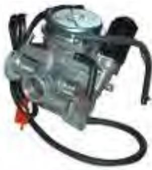
Figura 1. Carburador de motoneta Italika, Italika (2015)
