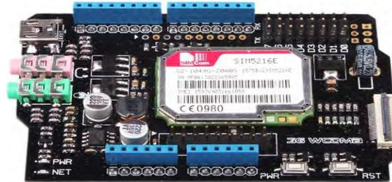
Figura 5. Esquema del módulo SIM5216E.
