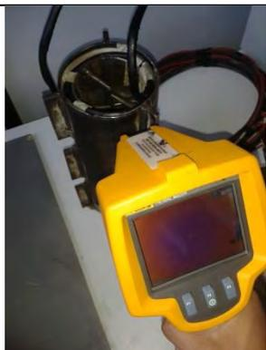
Figura 17. Medición de la temperatura en los tubos didipadores.
