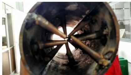
Figura 14. Disipadores (aletas) soldados en el interior del tubo.
