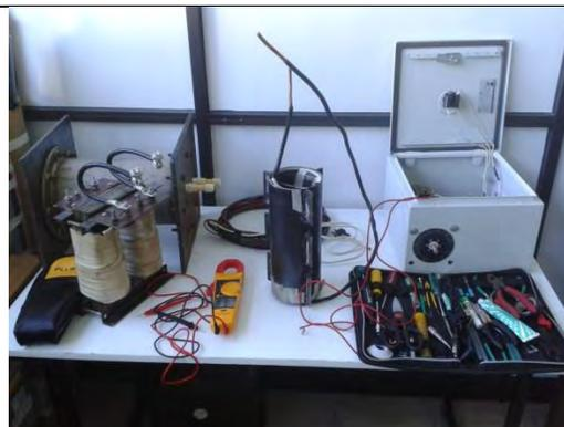
Figura 18. Elementos del sistema: Calefactor, transformador y control eléctrico.
