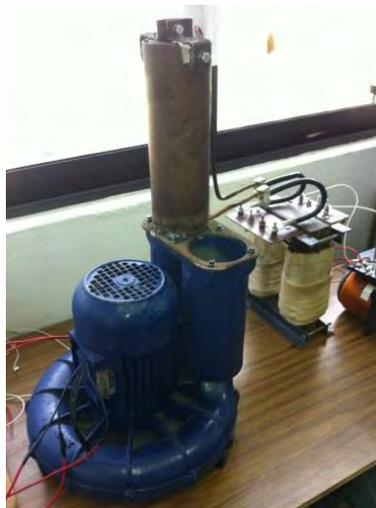
Figura 12. Prototipo del generador de aire por inducción (Turbina más motor y calefactor de inducción).
