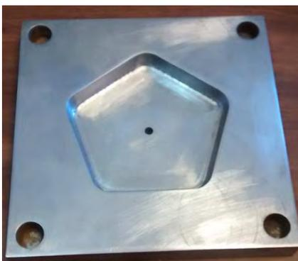
Figura 18 Cavity de molde fabricada con la estrategia de contorno.
