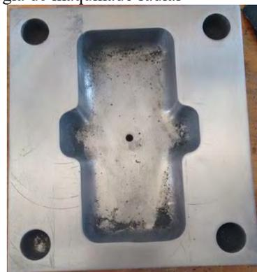
Figura 19 Cavity de jabonera manufacturada con la estrategia de maquinado por caja.
