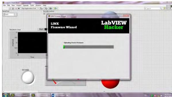
Figura 9. Se carga el firmware al arduino
