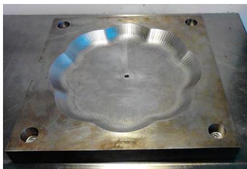
Figura 17 Cavity de plato fabricada mediante la estrategia de maquinado radial
