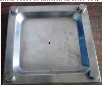
Figura 16 Cavity de charola manufacturada mediante la estrategia de maquinado paralelo
