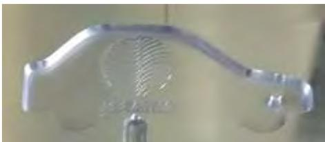
Figura 20 Cavity de llavero fabricada con la estrategia de paredes anguladas
