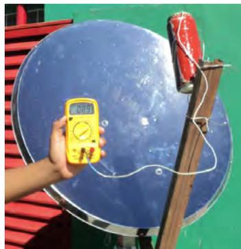
Figura 8. Lectura de la medición en el recipiente con aislamiento
