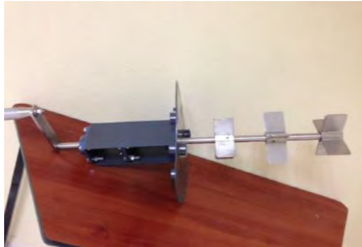
Figura 3 Agitador tipo paletas de acero inoxidable
