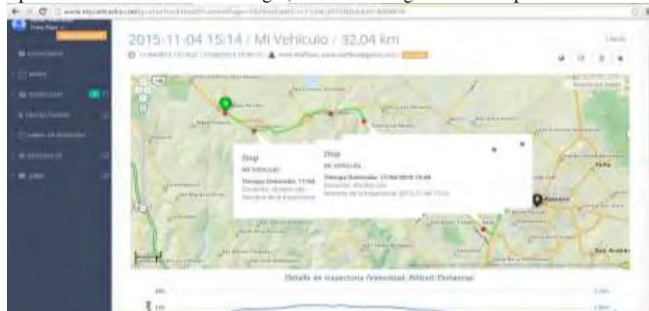
Figura 5. Se puede observar el recorrido en verde, el punto A en verde marca el origen en Diego Recoba y el B en negro el destino en Apizaco. También se puede ver los detalles de las paradas realizadas, en cuanto tiempo, la altitud, fecha y hora exactas.
