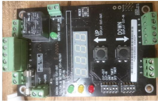
Figura 4.- Tarjeta principal del controlador.
