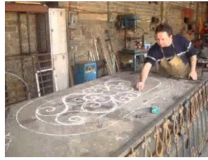
Figura 6. Dibujo con medida real para posterior forjado
