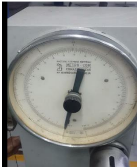
Figura 10 carátula de la máquina para de torsión calibrada en cero
