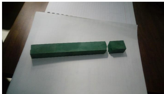
Figura 5 probeta después del ensaye de tensión
