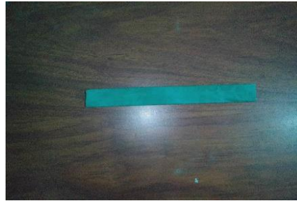
Figura 4 probeta antes del ensaye de tension
