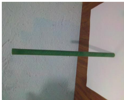
Figura 8 probeta del material NECURON 1001 para el ensaye de torsión
