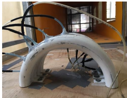
Figura 4. Modelo instrumentado dentro de la cámara de ensayos del túnel.
