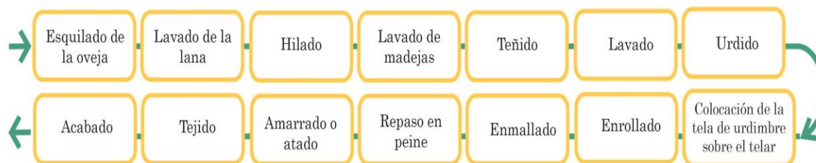
Figura 4. Proceso de manufactura de productos artesanales de lana. Fuente: propia
