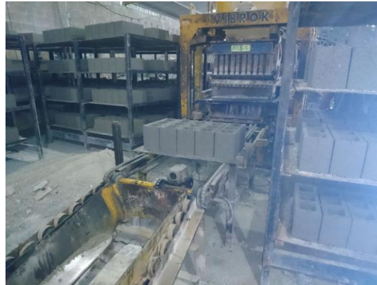
Figura 2. Equipo para la elaboración de los bloques
