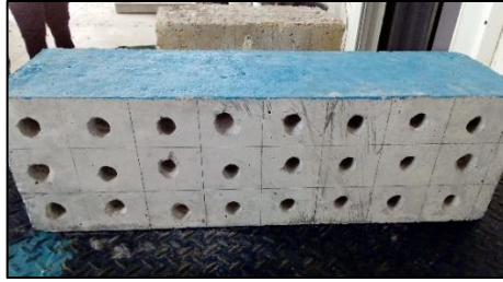
Figura 1. Espécimen de prueba perforado
