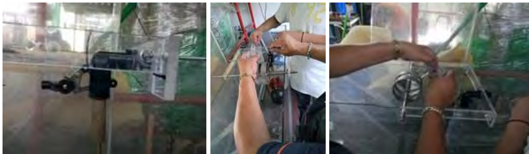
Figura 6. Montaje de los sistemas de palancas y trinquete.
