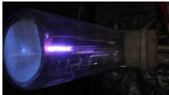
Figura 3.- Prototipo del tubo de rayos catódico en funcionamiento.
