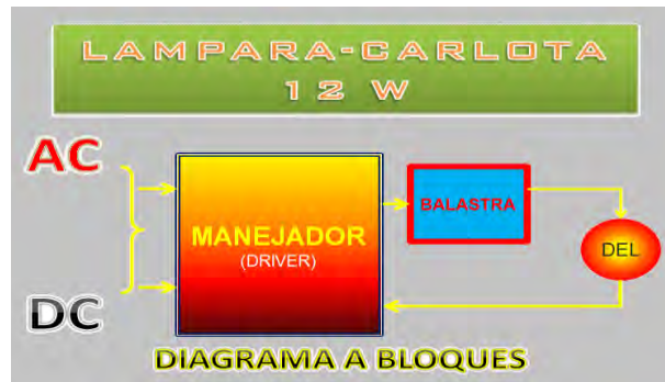
Figura 7. Diagrama a Bloques del circuito electrónico.
