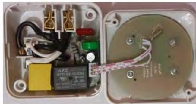
Figura 4. Aspecto interno del temporizador.
