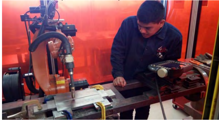
Figura 6. Celda de soldadura GMAW robotizada, con brazo robótico KUKA KR16.
