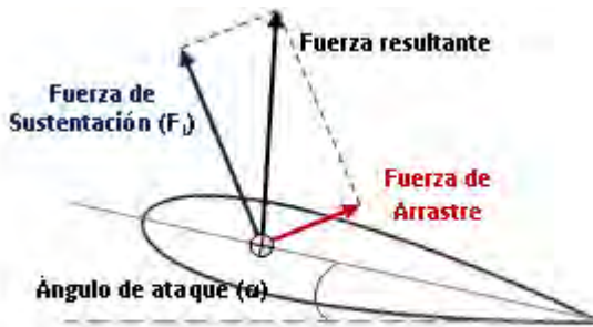
Figura 8. Fuerzas aerodinámicas actuantes sobre un perfil aerodinámico.
