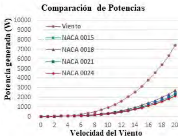
Figura 17. Gráfica de las potencias de los perfiles aerodinámicos y potencia del viento a diferentes velocidades.
