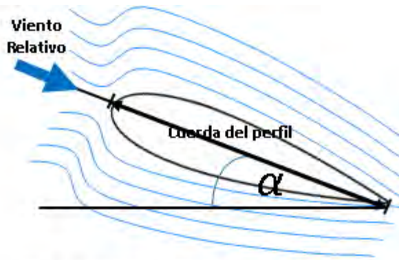
Figura 7. Ángulo de ataque ( \alpha ) formado por el viento relativo y un perfil aerodinámico.
