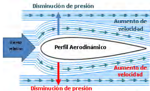
Figura 6. Características actuantes sobre un perfil aerodinámico.
