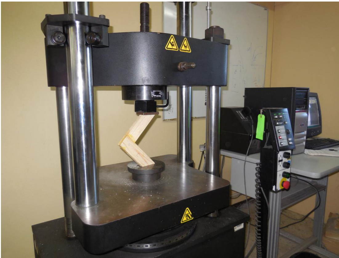
Figura 3. Máquina Universal de Ensayos Mecánicos
