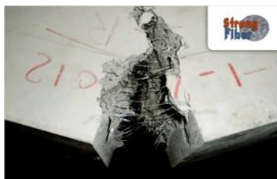
Figura 1.- Efecto de fibras en el concreto. Dificonsas 2018
