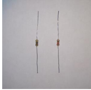
Figura 5. Resistencias de 1 MOhm (lado izquierdo) y 220 Ohms (lado derecho).
