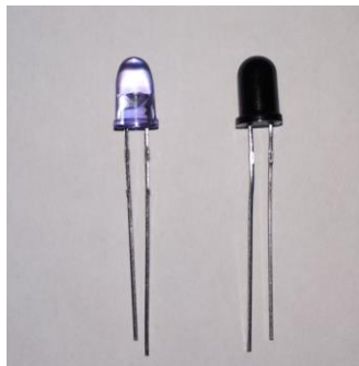
Figura 2. Led infrarrojo del lado izquierdo (emisor), fotodiodo del lado derecho (receptor).
