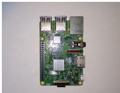
Figura 8. Raspberry Pi 3 modelo B.
