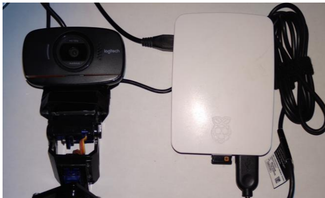
Figura 11. Conexión entre cámara y Raspberry Pi.
